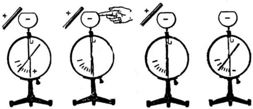
Рис.1. Четыре стадии электризации электрометра через влияние
