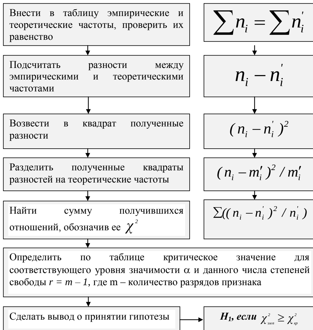
Рисунок 11. Пример фрейма-алгоритма «Расчет критерия согласия Пирсона»
