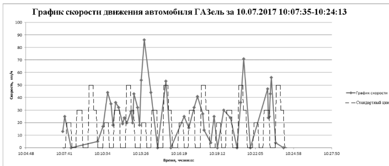
Рис. 4. Сравнение скоростного режима автомобиля ГАЗель со стандартным ездовым циклом
