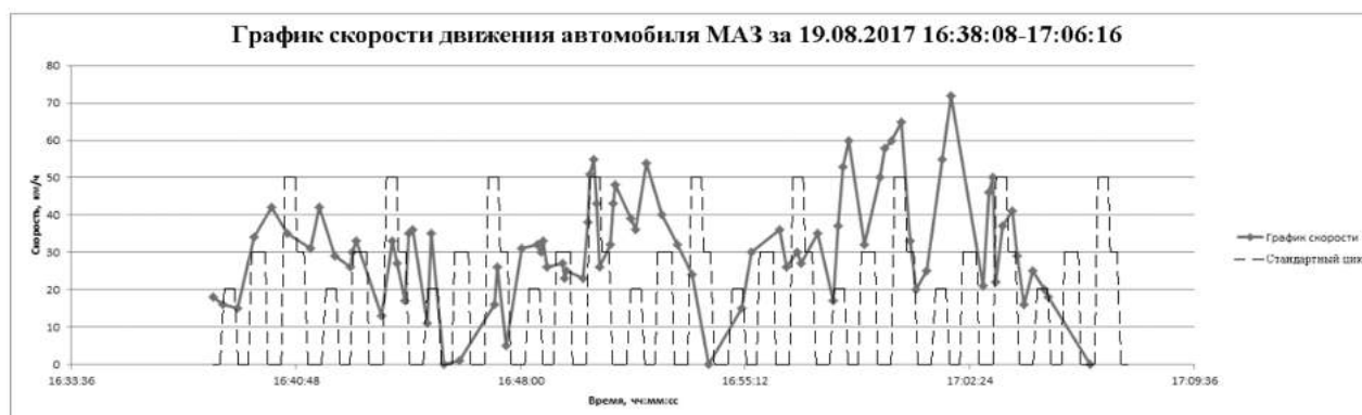
Рис. 2. Сравнение скоростного режима автомобиля МАЗ со стандартным ездовым циклом
