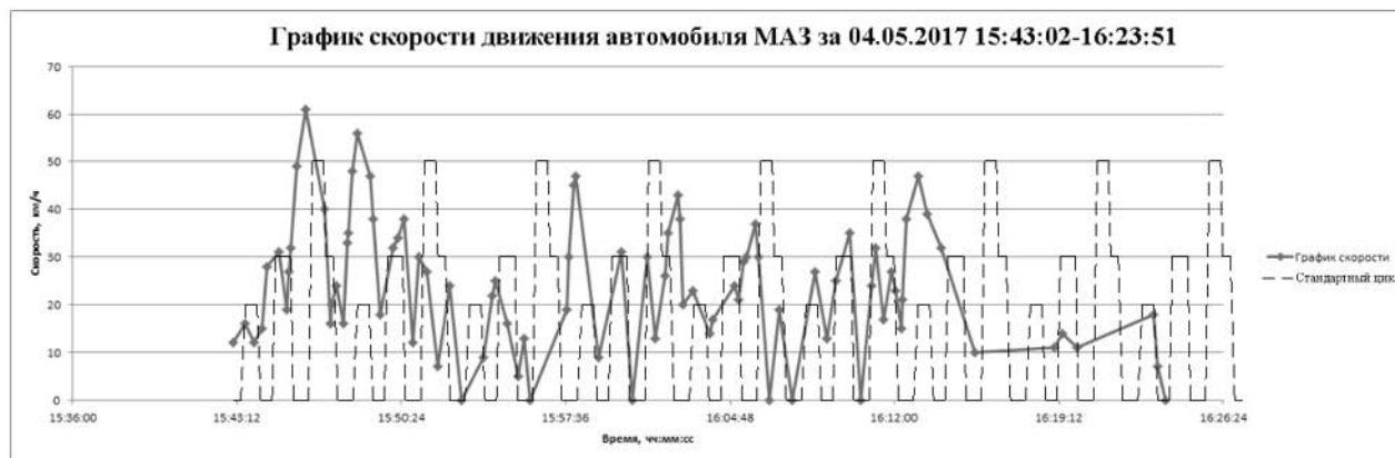
Рис. 1. Сравнение скоростного режима автомобиля МАЗ со стандартным ездовым циклом
